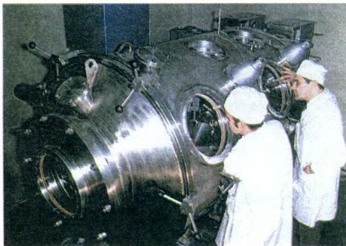
Лаборатория, в которой производились приемка и первичные исследования лунных образцов, доставленных на Землю советскими АЛС "Луна-16", "Луна-20" и "Луна-24". Слева – приемная камера с инертным газовым наполнением; в центре – высоковакуумная камера. Фото ГЕОХИ им. В.И. Вернадского.
